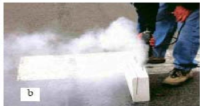
taglio con attrezzatura munita di dispositivo (b) e in assenza di dispositivo di aspirazione (a)
